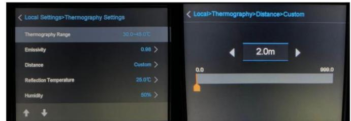
2. Vaya a Termografía, Establezca “punto caliente”, “Punto central” y otras reglas según se requieran.
