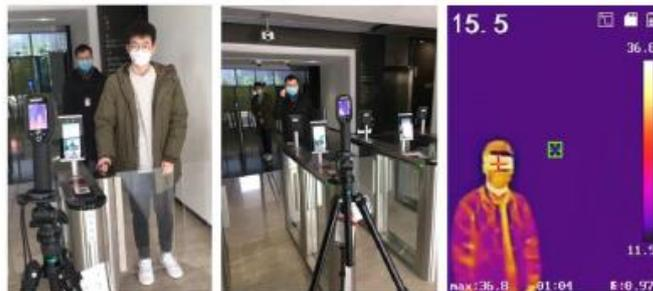
Se recomienda configurar la altura de instalación como mínimo entre 1.5-1.7m, es decir, la cámara debe configurarse con la misma altura de rostros humanos, o incluso con un ángulo de baja elevación, lo que reduce el error causado por otras fuentes de calor cerca del suelo.
