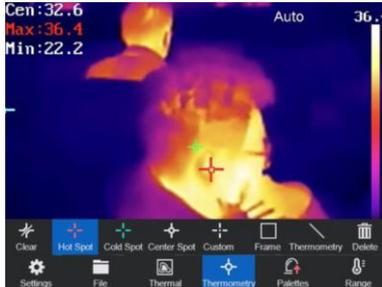
3. Vaya a “Palettes”, establezca la temperatura de la alarma (arriba) como requisito. Cuando el valor medido excede el valor establecido, el valor de temperatura máxima cambiaría a color rojo y parpadearía como se muestra a continuación.
